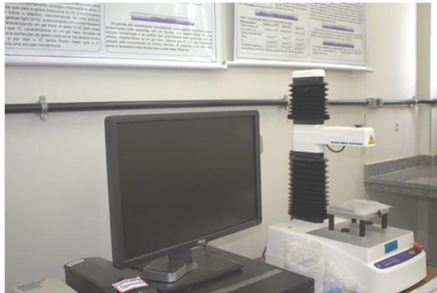
**Imagem 9. Equipamento para análise de textura (Texturômetro)**
